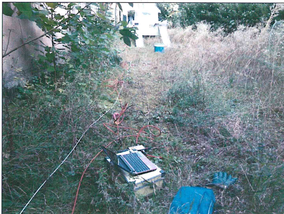
Vista dello stendimento MASW effettuato
